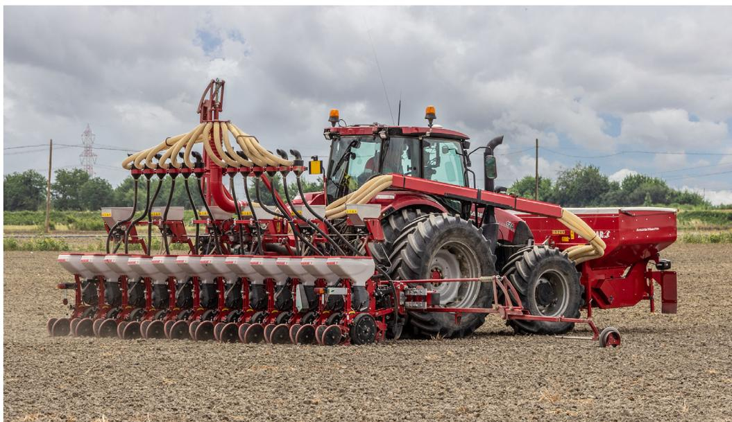
Per Multiflex l'elemento Maxi viene fornito solamente nella versione "corta" cioè con parallelogramma accorciato, per ottimizzare il bilanciamento del peso a sbalzo, utile soprattutto in fase di manovra o in presenza di terreni in pendenza.
