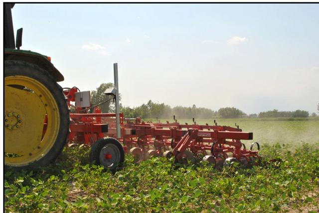
La macchina è provvista di sistema CULTICAM MK4HD con camera a doppia lente verticale ad alta risoluzione, per il riconoscimento della pianta e distinzione dalla malerba. Questo sistema risulta efficace già dai primi stadi colturali, quando diventa distinguibile la linea della coltura dall'interfila e dalle infestanti.
