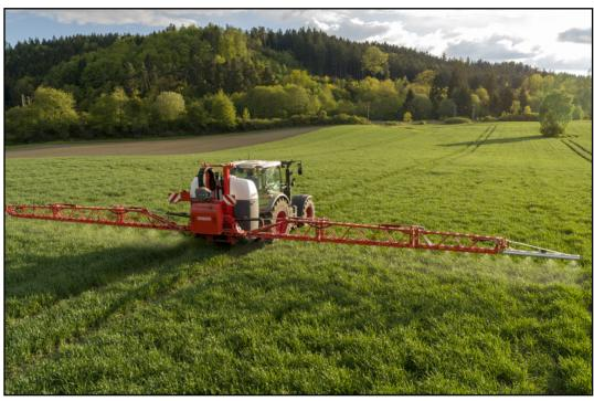
tivante e compatto, comfort di utilizzo e dai cicli funzionali semplificati grazie alla versione isobus "ISOTRONIC" associata all'Hydric Panel, pannello di comando del circuito acqua che permette di effettuare le diverse operazioni di lavoro dalla cabina del trattore ed in modo automatico. L'attrezzatura è disponibile con cisterne da 1300, 1600 e 2000 litri e barra dai 21 ai 27 metri.
